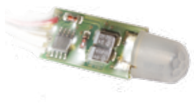
DT40-SW Inbouwdetector klein in muur | plafond - wit Bewegingsdetector voor inbouw in kleine ruimtes, ook geschikt om in een blind plaatje van eender welk merk in te bouwen. Bereik van 4 meter 360°.
